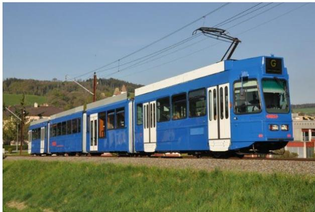
*Anfangs Juli waren bereits fünf RBS-Trams um eine von der Firma Stadler gebaute „Sänfte“ verlängert (viertes Wagenelement mit Niederflur-Einstieg). Dieser erleichtert den Zugang mit Kinderwagen und Rollstühlen und erhöht die Passagierkapazität.*
